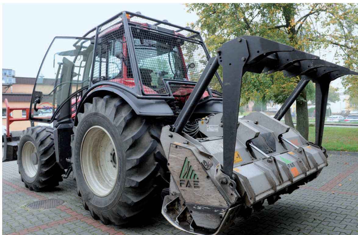
Zestaw do likwidacji zadrzewienia pod liniami energetycznymi. Ciągnik rolniczy VALTRA T214V i rozdrabniacz typu Mulczer FAE UMM/DT-225
