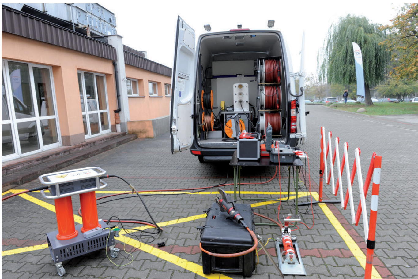
Samochód do lokalizacji uszkodzeń i diagnostyki linii kablowych SN w układzie trójfazowym Mercedes Sprinter 516 CDI
