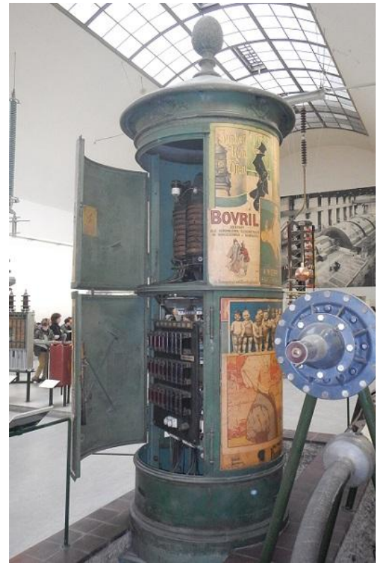
Muzealne przykłady stacji transformatorowych z początku XX w, z obsługą z zewnątrz
