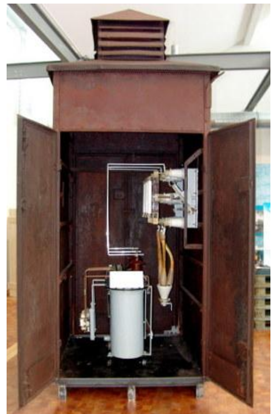
Muzealne przykłady stacji transformatorowych z początku XX w, z obsługą z zewnątrz
