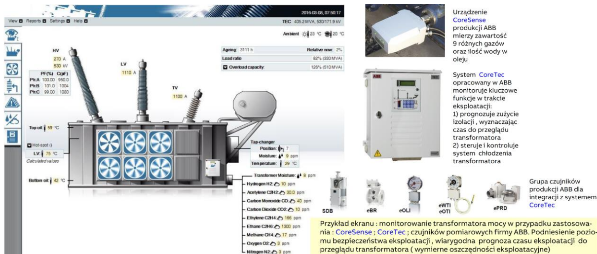
Rys. 13c. Monitoring transformatora mocy , przykład ekranu roboczego po zastosowaniu : CoreTec ; CoreSens , oraz sensorów pomiarowych skonstruowanych i produkowanych w ABB .
