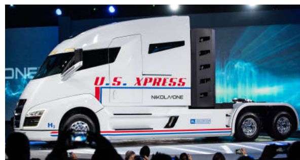
Rys. 4. Ciągnik siodłowy Nikola One o napędzie wodorowym do holowania typowych kilkunastotonowych naczep ciężarowych [fot. Nikola Motor Company]
