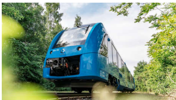
Rys. 5. Zespół trakcyjny typu Coradia iLint zasilany z wodorowych ogniw paliwowych zbudowany przez zakłady Alstom od roku znajduje się w regularnej eksploatacji [fot. Alstom].
