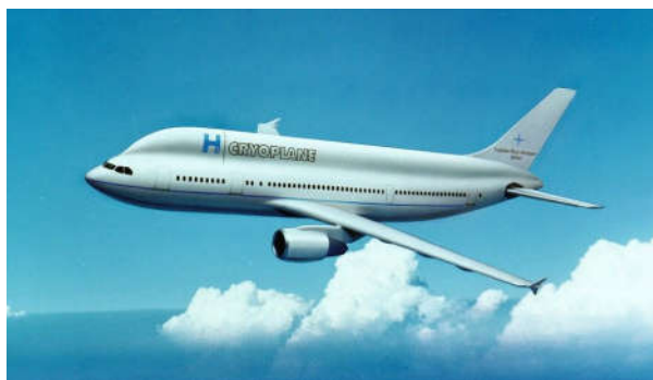
Rys. 7. Koncepcja samolotu wodorowego. Zbiorniki paliwa umieszczone są w górnej części kadłuba, nad kabiną pasażerską.
