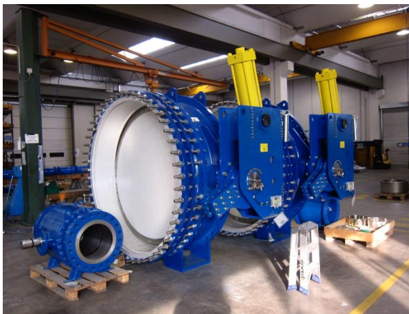
Fot.1 Przepustnice DN2200 PN6 w wersji zintegrowanej ze wstawkami montażowymi, wyposażone w napędy hydrauliczne (etap przed montażem przeciwwag). Obok zawory iglicowe DN300 PN10 (etap przed montażem napędów) [1]
