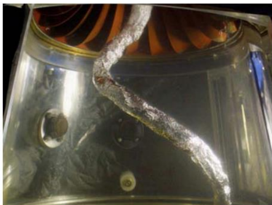
Rys.3 Wir sznurowy w obszarze niedociążenia turbiny Francisca – projekt FLINDT [7]
