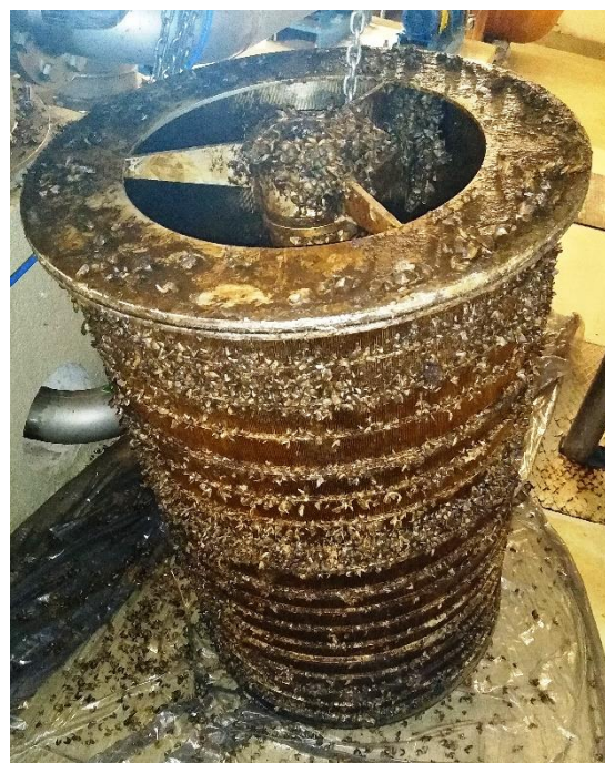
Zdj. 3 Wkład filtracyjny bez powłoki po badaniach eksploatacyjnych
