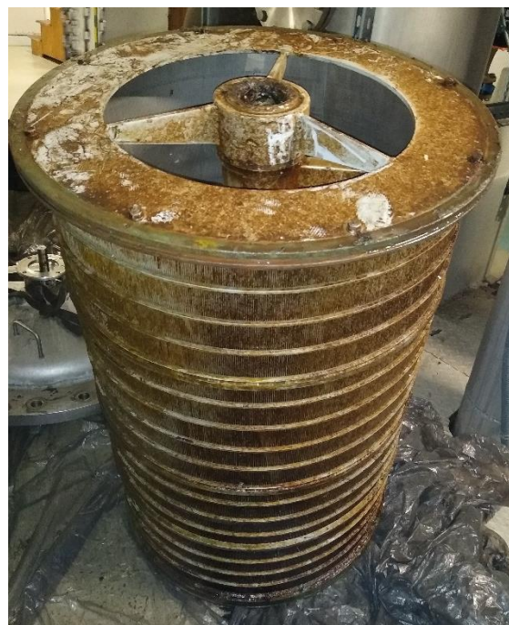
Zdj. 2 Wkład filtracyjny z powłoką antyporostową po badaniach eksploatacyjnych
