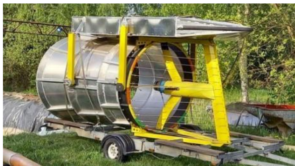
Rys. 4 Prototypu hydrozespołu z pływakiem
