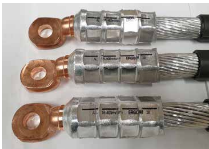
Rys. 7. Zdjęcia próbek przed wykonaniem próby wytrzymałości mechanicznej
