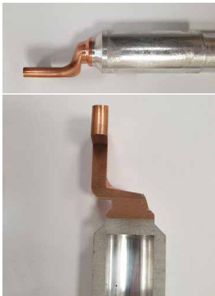
Rys. 4. Połączenie Al-Cu w końcówce KMA
