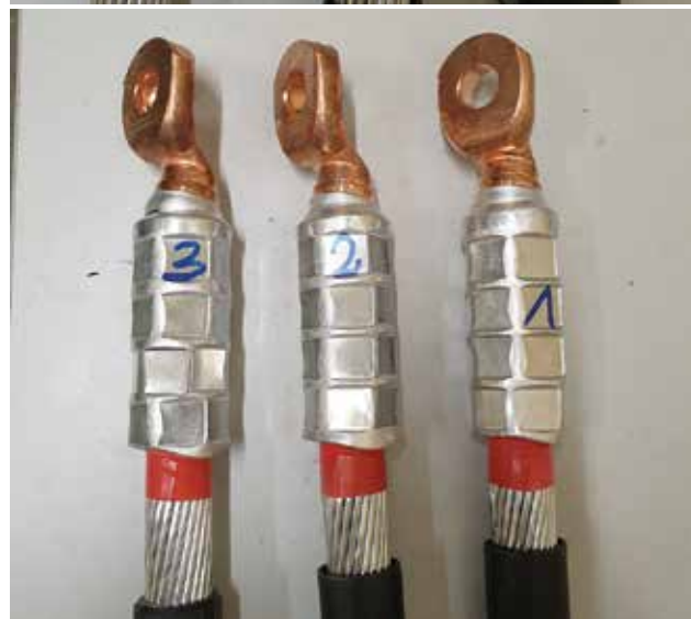
Rys. 8. Próbki po wykonaniu próby wytrzymałości mechanicznej na rozciąganie
