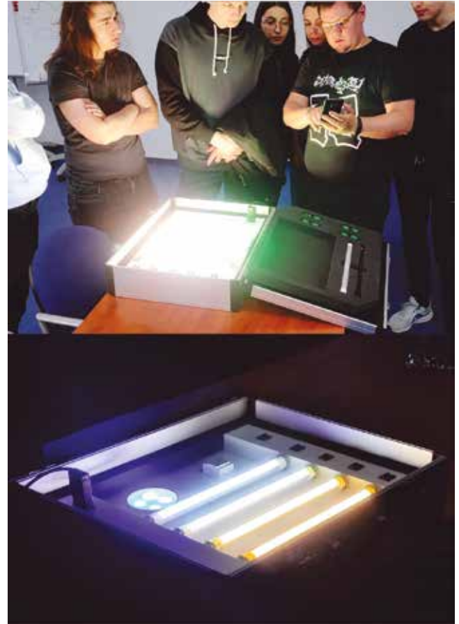
Regulacja strumienia świetlnego oraz barwy światła za pośrednictwem smartfona (bezprowadowa komunikacja z zastosowaniem modułów CASAMBI®)
