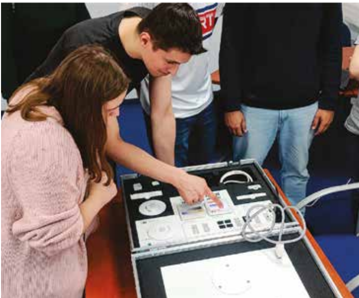
Manualne (przewodowe) sterowanie oprawami oświetleniowymi po protokole DALI z użyciem systemu sterującego APCON
