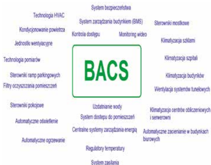
Rys. 4. Przykład integracji funkcjonalności budynkowych w systemie BACS
