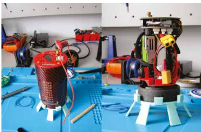
Rys. 2. Mikrosatelita zespołu NERV. Widoczne otwory wentylacyjne (umożliwiające pomiar temperatury zewnętrznej i ciśnienia)
