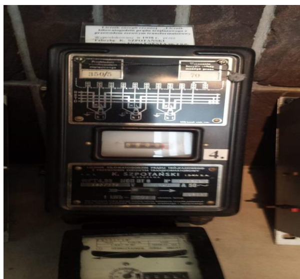
Licznik energii czynnej, wyprodukowany w 1938r. przez fabrykę K.Szportanski. (Wiesław Lelek)
