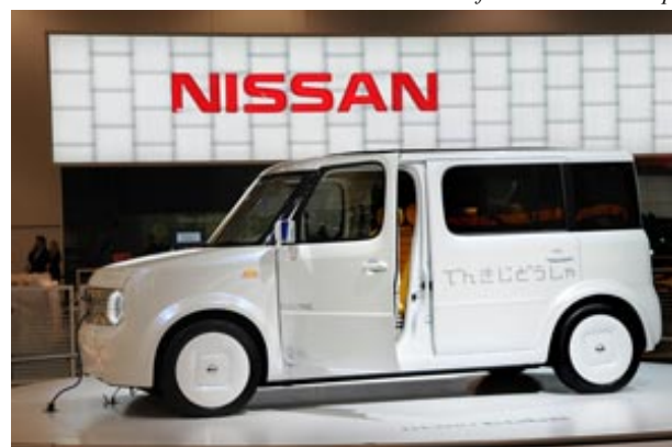
Fot. 14. Na Zlocie w Gdyni Nissan przedstawił po raz pierwszy w Europie Środkowo-Wschodniej model CUBE Denki na Zlocie Pojazdów Elektrycznych i Hybrydowych – benzynowy silnik 1,3 litra zastąpiony został jednostką elektryczną oraz najnowszymi akumulatorami litowo-jonowymi, umieszczonymi pod podłogą oraz pod siedzeniami.
