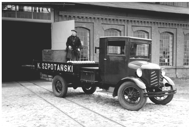
(Zdj. 2) Jeden z dwóch samochodów ciężarowych z napędem elektrycznym w FAE w okresie wojny
