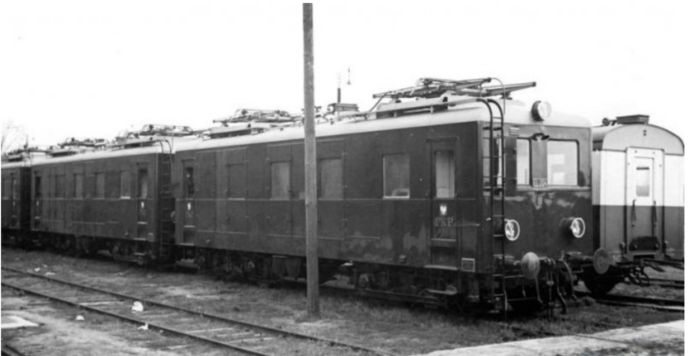
Lekkie lokomotywy manewrowe EL.200 wyprodukowane w Zakładach Cegielskiego w Poznaniu. Trzy z czterech takich pojazdów zostało zniszczone we wrześniu 1939 r.
