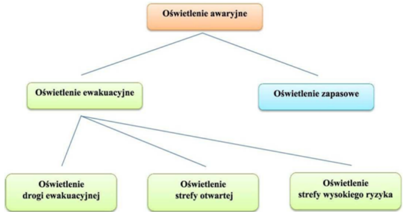
Rys. 1. Rodzaje oświetlenia awaryjnego, wg normy PN-EN1838:2005
