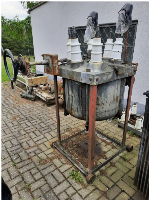
Fot.2 Wyłącznik pełno olejowy produkcji Szpotańskiego z lat po przejęciu fabryki (autor Andrzej Jutrzenka)
