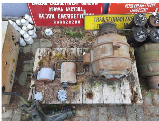
Fot.5 Układ załączający silnik indukcyjny gwiazda-trójkąt (autor Andrzej Jutrzenka)
