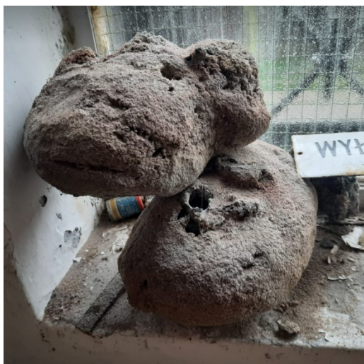
Fot.9 Fulguryty-Stopiony piasek podczas zwarcz doziemnych (uderzeń pioruna w słup i odprowadzenia wyładowania do ziemi) nazywanych skamieniałym piorunem (autor Andrzej Jutrzenka)
