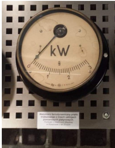
Watomierz ferrodynamiczny prądu trójfazowego o trzech ustrójach pomiarowych platynowych, pochodzący z Elektrowni Miejskiej w Rzeszowie z lat 20. (Wiesław Lelek)
