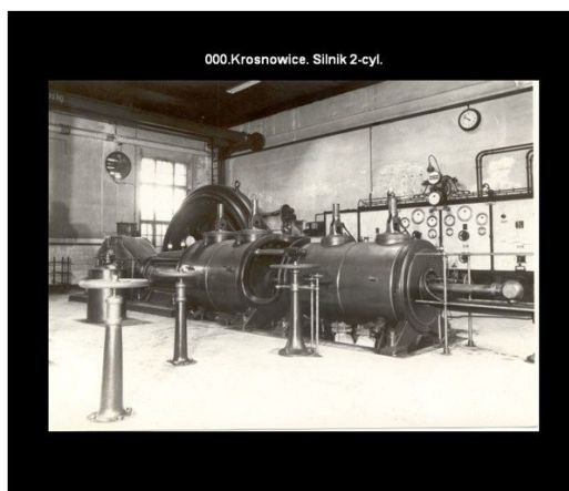
Fot. Silnik 2-cylindrowy znajdujący się w Siłowni energetycznej w Krosnowicach (źródło: http://fomt.pl/muzeum/wroclaw/krosnowice/img/001.jpg )
