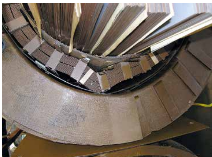
Rys. 3. Odkształcenie uzwojenia DN fazy L3
