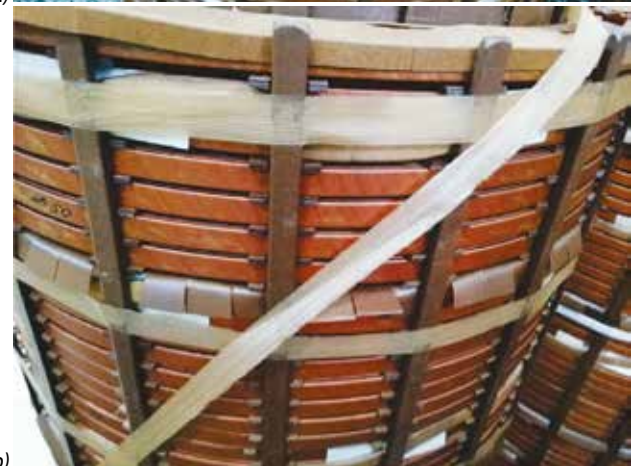
Rys. 9. Widok zamontowanych kierownic przyciśniętych klinem
