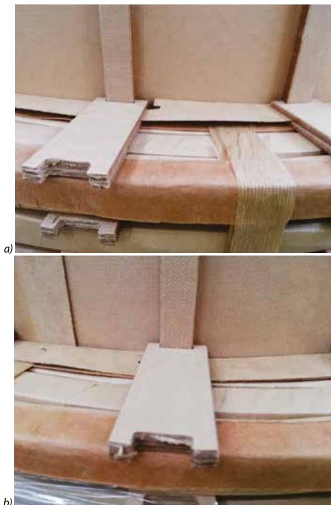
Rys. 11. Widok uzwojeń z jednego transformatora z różnymi montażami kołnierzy kątowych
