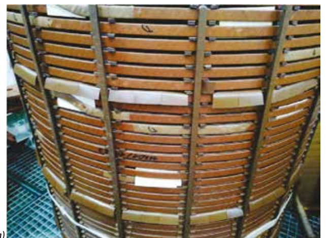
Rys. 8. Widok uzwojeń z nieprawidłowo zamontowanymi kierownicami
