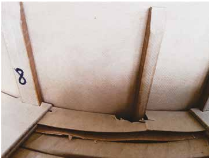
Rys. 7. Widok uszkodzonej kierownicy
