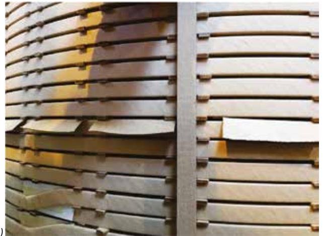
Rys. 8. Widok uzwojeń z nieprawidłowo zamontowanymi kierownicami
