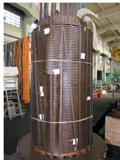
Rys. 7. Uzwojenie DN faza L3
