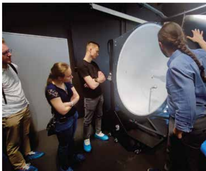
Prezentacja kuli całkującej współpracującej ze spektrometrem
